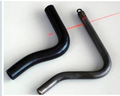
Comparaison de tube-mandrin – génération graphique des données de scan et sortie simultanée des données xyz et des données de cintrage, ainsi que correction des données selon le type de cintruse
