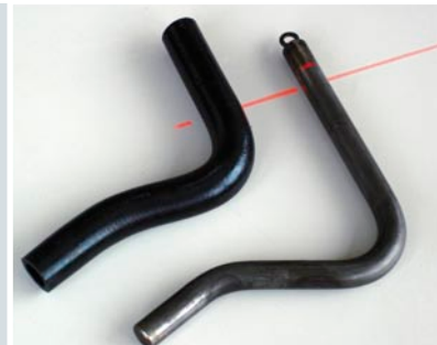
Schlauch-Dorn Vergleich – graphische Generierung der Scan-Daten und zeitgleiche Datenausgabe in xyz und Biegeformat sowie Datenkorrektur entsprechend des Biegemaschinentyps
